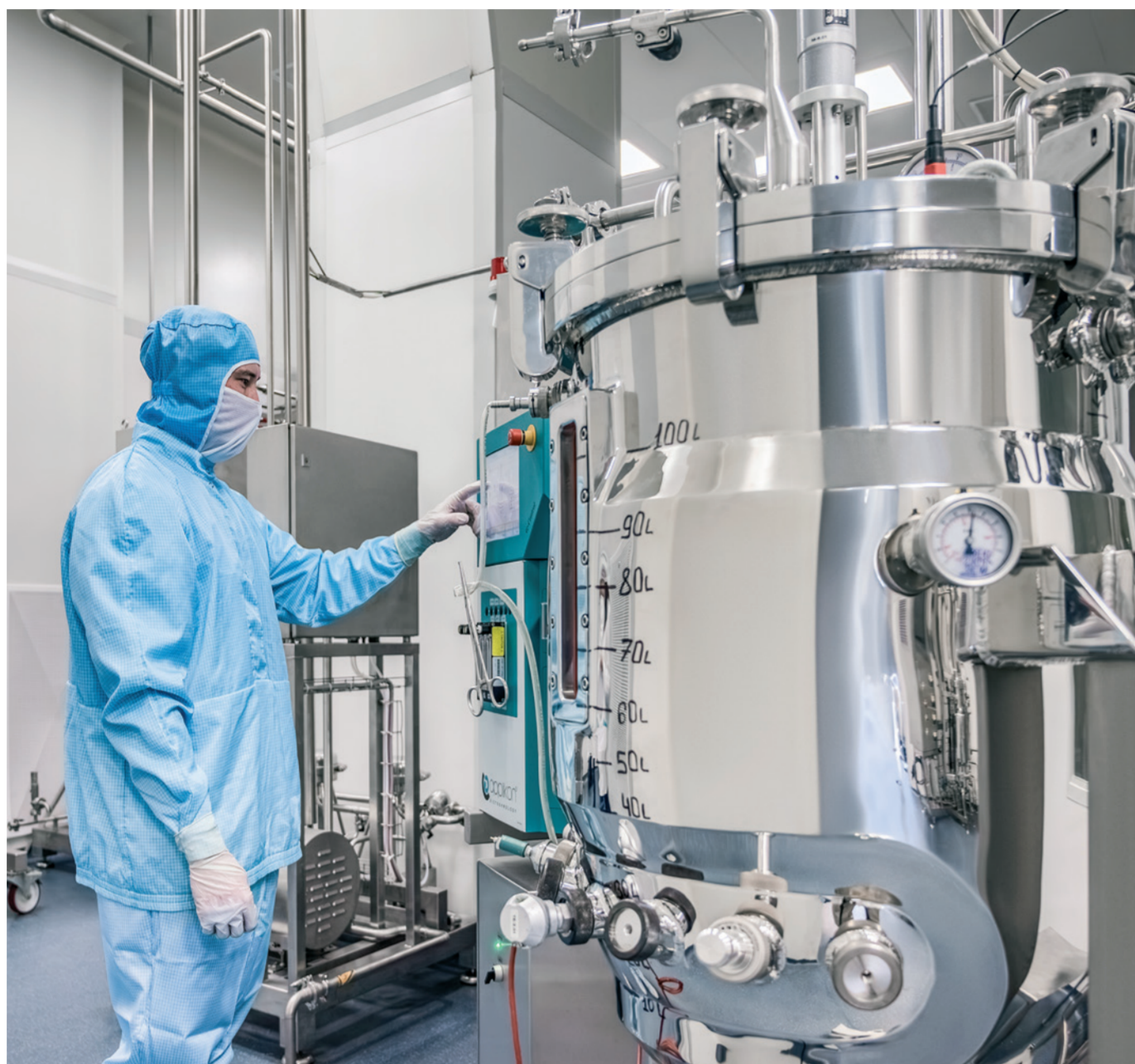
Современное оборудование позволяет вести суспензионное культивирование культуры клеток в масштабах биотехнологического производства
