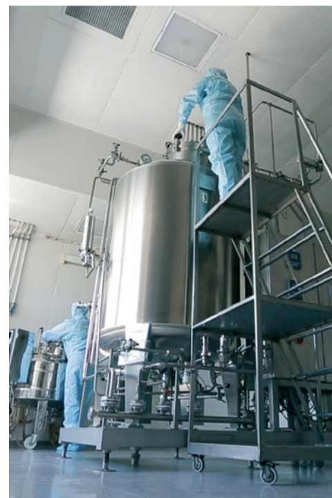
Цех по производству биопрепаратов, биоферментеры для культивирования аэробных микроорганизмов ФКП «Армавирская биофабрика»
