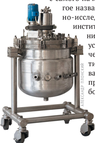
Экспонат музея – реактор для наработки вирусов суспензионным методом (1975 г.) Предназначен для суспензионного культивирования клеток и вирусов при изготовлении вакцин.
